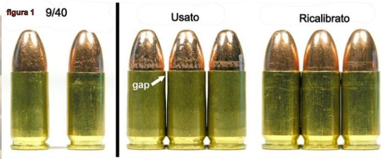
L'uso durante le fasi di ricarica, di bossoli preventivamente ricalibrati, fa si che le presse lavorino con **IL MINIMO SFORZO POSSIBILE**, evitando il formarsi di "giochi" tra i vari leverismi delle presse stesse, le quali, come noto sono costruite in zama, lega di alluminio molto tenera e soggetta ad usure repentine.
